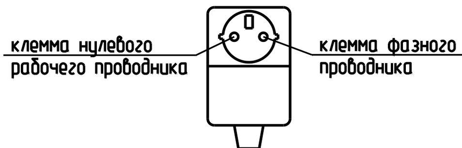
Рисунок 2. Схема расположения фазного и нулевого контактов УЗО
