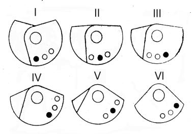
Рисунок 4. Схема регулировки статического момента. Таблица 6.
