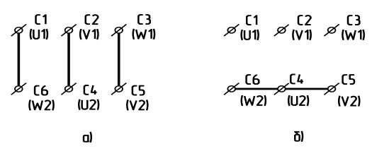
Рисунок 4. Схема соединения обмоток статора:
